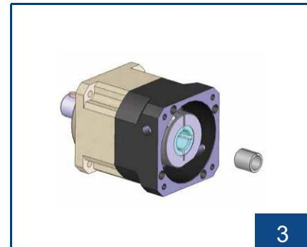
检查马达出力轴尺寸, 如需轴套, 请先装进入力孔内。
