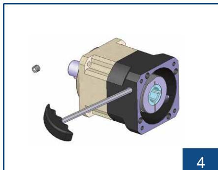
取出塞头, 使用六角扳手将迫紧环螺丝松开。并将螺丝对准孔位。
